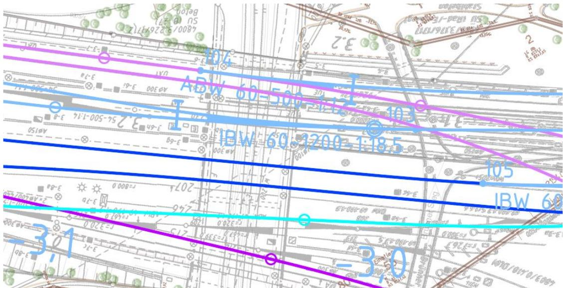
Abbildung 4: Lageplan Bereich Heilbronner Straße. P-Option in lila, der Zulauf der Ergänzungsstation in hellblau (Richtung Hbf auf der Trasse der heutigen S-Bahn), die nach Süden verlegten S-Bahn-Gleise in dunkelblau.
