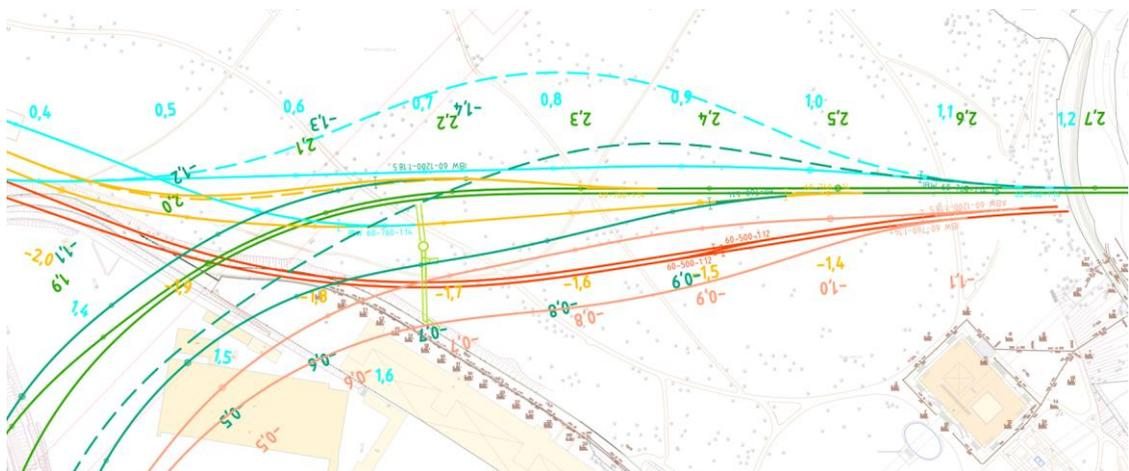
Abbildung 15: Verzweigungsbereich für Ergänzungsstation (tannengrün), sowie Nordkreuz (orange) und T-Spange (cyan) unterhalb des Rosensteinparks. Fernbahnzulauf Bad Cannstatt in rot, S-Bahn in grün. In blassem rot die optionale Anbindung der Ergänzungsstation an die Fernbahn. In hellgrün die Anlagen des Rettungsschachtes am Rosensteinpark.
